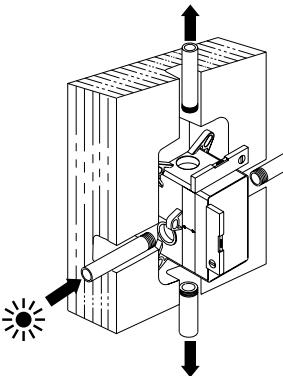
■ Collegare i tubi dell'acqua calda e fredda in entrata del rubinetto, e i tubi in uscita.
