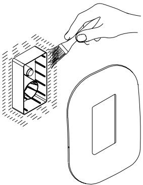
■ Mettere la colla sulla parete con un pennello, appoggiare la guarnizione facendola aderire bene al muro e al **Pbox**.
