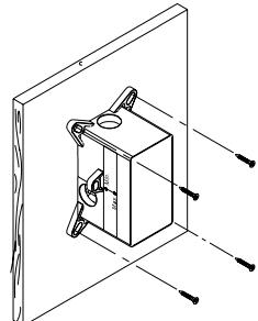
■ Nel montaggio su pannello in legno o cartongesso utilizzare le apposite asole poste agli angoli estremi del **Pbox** e serrare con viti.
